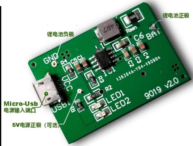
可以提供 PCB-layout, 完整 BOM 选择。(需注意 5 脚模拟地和散热片的功率地尽量直接铺铜不要有缠绕交叉)
