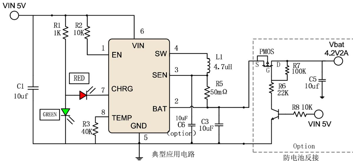
注释: 1,  $C1 \geq 10\mu F$  不可省略, 尽量靠近 Vin 引脚。C3 尽量靠近 Bat 引脚。
